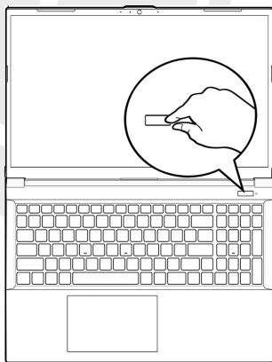
Schéma 1 - Ouverture du couvercle/de l'ordinateur avec l'adaptateur CA/CC branché
