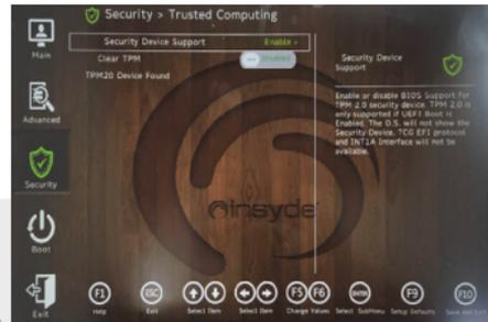
Abbildung 24 Sicherheit - Trusted Computing
