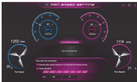
Figura 9 - Configuración del control de velocidad/ ventilador antipolvo
